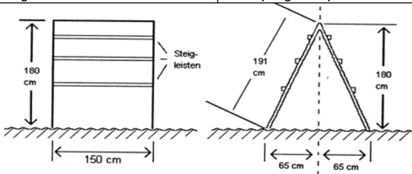
La palissade est composée de deux parties fixées solidairement d'une largeur de 150 cm et d'une hauteur de 180 cm. Au sol, ces deux parties sont écartées de telle façon que le sommet se situe à 180 cm. Toute la palissade doit être recouverte d'un revêtement antidérapant. Dans la partie supérieure des côtés, sont disposées 3 lattes (24X48 cm), pour faciliter le franchissement.
